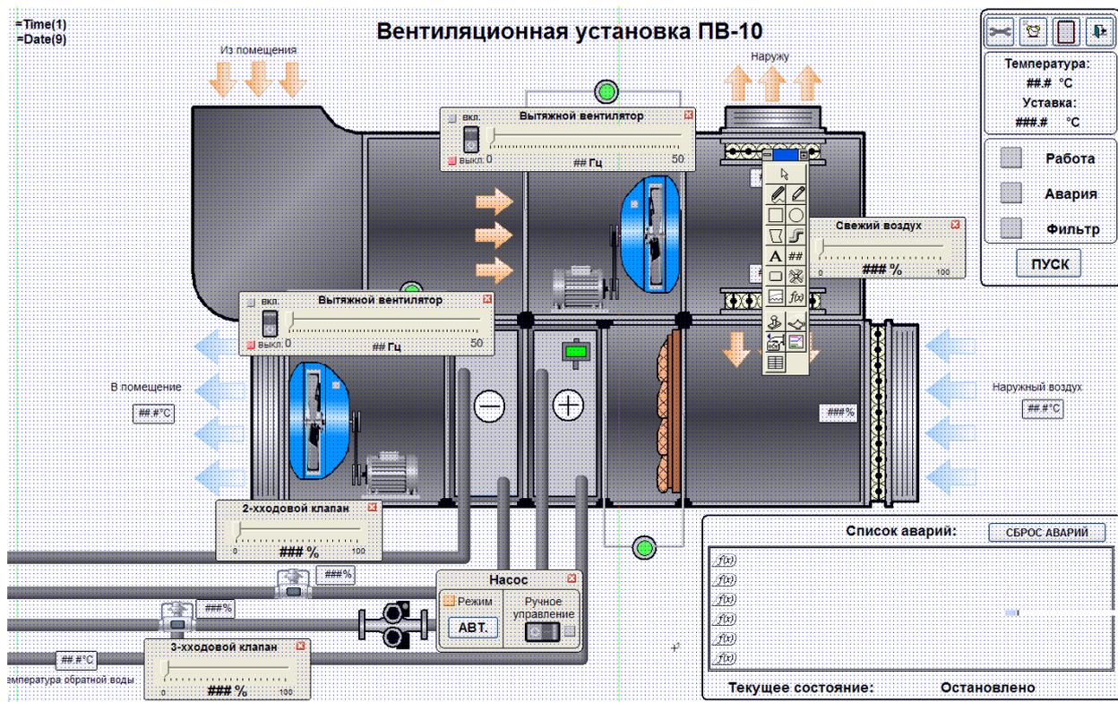
Сверху изображена камера вытяжки, где располагается вытяжной вентилятор с собственным частотно регулируемым приводом, количеством оборотов которого можно управлять с помощью ползунка «*Вытяжной вентилятор*». Он определяет частоту тока, подаваемую на инвертор привода вытяжного вентилятора. При изменении ее от 0 до 50 Гц количество оборотов в привода меняется от минимального до максимального значения.
